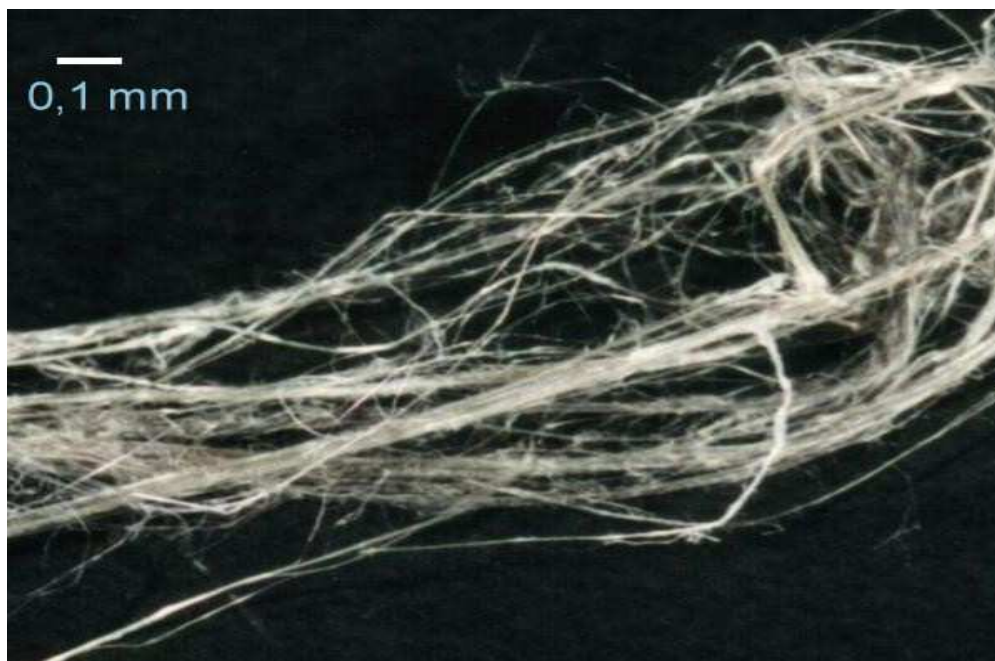
Ryc. 2 Zdjęcie mikroskopowe materiału zawierającego azbest – widoczna struktura rakotwórczych włókien – zdjęcia [2]
