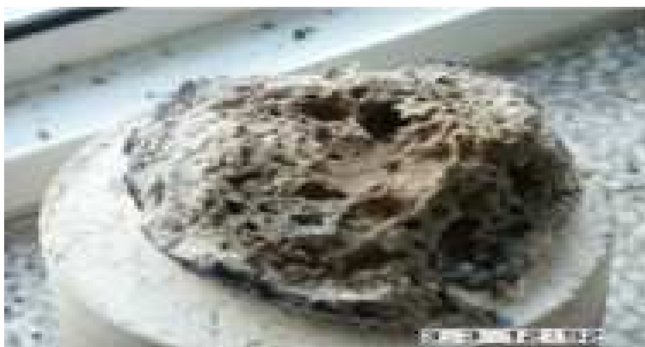
Ryc. 4 Zutylizowany azbest w technologii MTT( przy zastosowaniu małego reaktora mikrofalowego [2]
